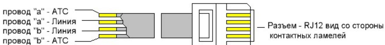
При установке измерительного шнура в ячейку кросса (плинта) с размыкаемыми контактами, провода линейной и станционной сторон сохраняют свое соединение через прибор кросса только в исходном состоянии и в дополнительных режимах.
